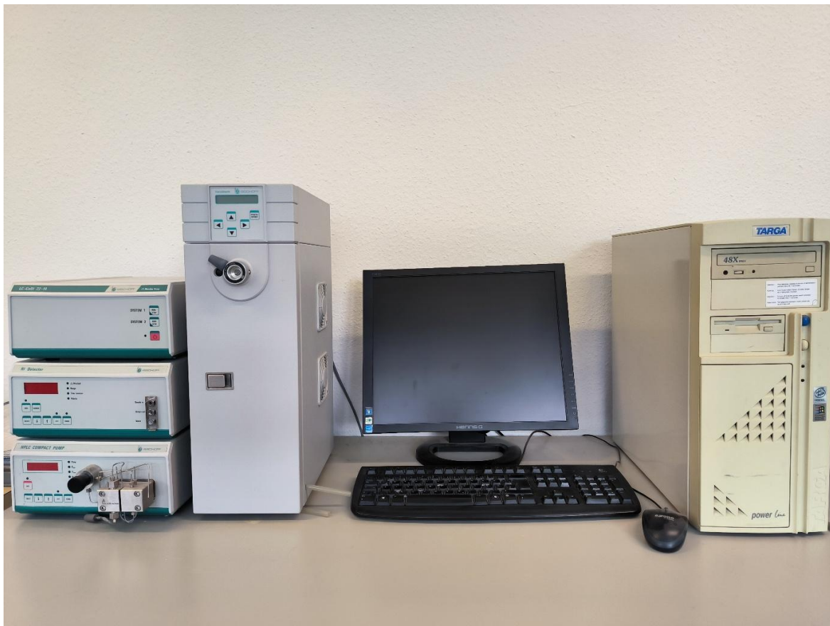
HPLC-System mit HPLC- Pumpe, RI-Detektor, Interface, Säulenthmostat und Software · Bild 1
